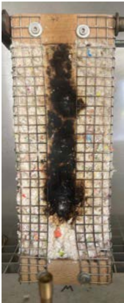
Abb. 1 Flammtest ohne Brandschutzmittel
