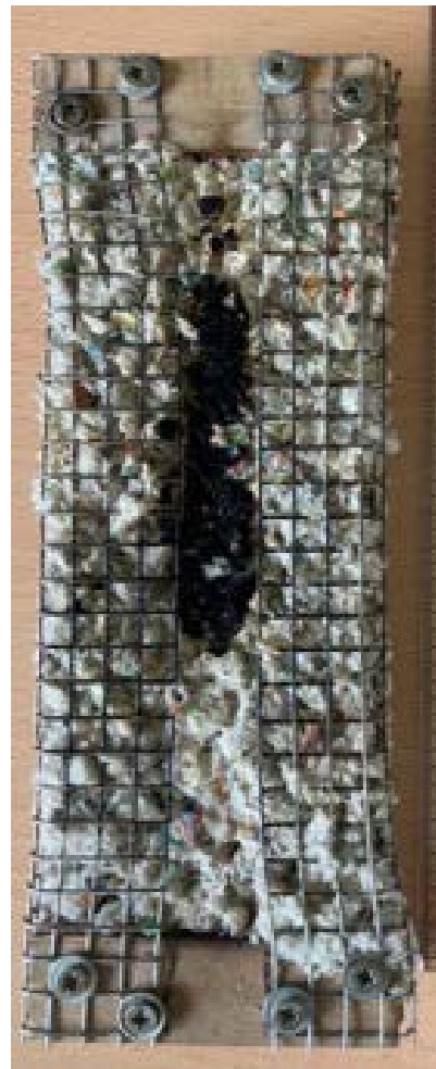
Abb. 2 Flammtest mit Brandschutzmittel
